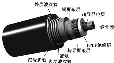
图 1 冷绝缘高温超导电缆结构示意图
