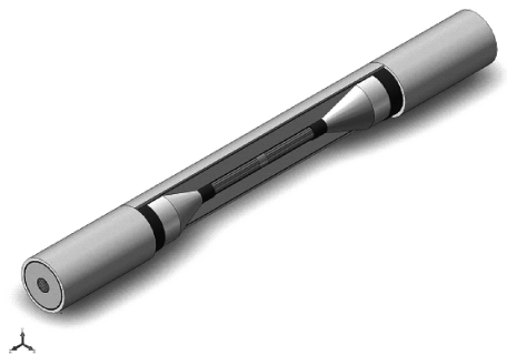
图3 典型的电缆中间接头示意图
