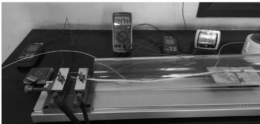
图 2 载流量试验装置
